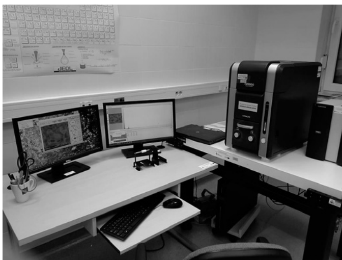
Fotografia 2. Mikroskop elektronowy SEM Hitachi TM-3000 w Centrum Badań nad Innowacjami
