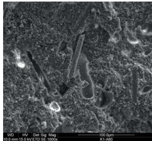
Rys. 4. Porowata struktura opoki –skaningowa mikroskopia elektronowa SEM (x1000)
