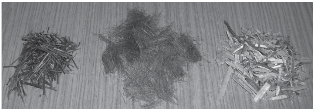
Rysunek 3. Próbkki wykorzystanych materiałów w badaniach. Od lewej: słoma lniana, włókno lniane, paździerz konopne [archiwum autorów]
