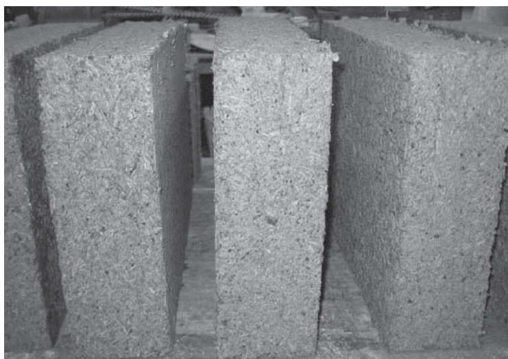
Rysunek 6. Bloki ściennie z kompozytu na bazie konopi [Bevan i Woolley 2010]
