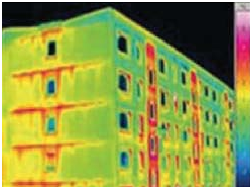
Rys. 1. Termogram budynku mieszkalnego z obszarami wyraźnego ubytku ciepła ( www.izolacje.com.pl )
